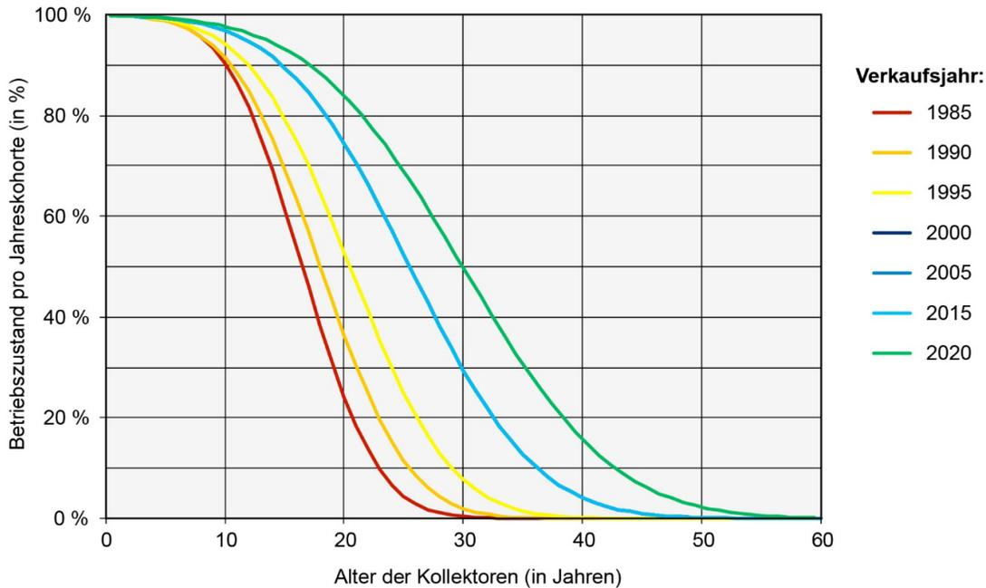
Für alle Modelle wird die Streubreite auf ein Drittel der mittleren Lebensdauer berechnet.
